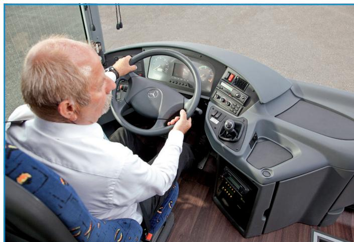
L'Intouro de Mercedes existe en 3 longueurs. Le poste de conduite est bien conçu avec le levier de vitesses intégré à la planche.
